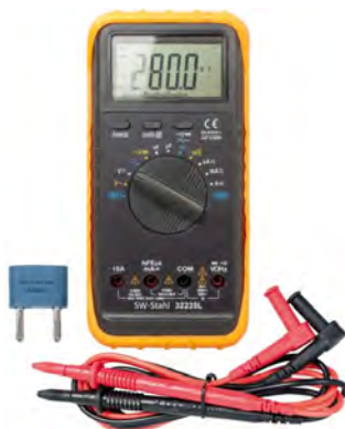
1605-005 Multimeter mit automatischer Bereichswahl - Alle Messbereiche - Messung von Gleich- und Wechselspannung bis max. 600V - Messung von Gleich- und Wechselströmen - Gleichstrom 10A - Messung von Widerständen - Transistorprüfung - Diodenprüfung - Messwerthaltefunktion - Holdtaste - Messkabel mit Berührungsschutz - Akustischer Durchgangsprüfer - Temperaturmessung -20° bis +400° C - Gummischutz und Aufsteller - DCV: 200mV - 600V / ACV: 200V - 600V / DCA: 200µA - 10A
