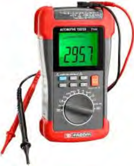
F714A Multifunktions-Prüfgerät mit Digitalanzeige • Stromkreise durch Sicherungen geschützt : 0,4 A HPC - 600 V ; 12 A HPC - 600 V. • Folgende Messungen können durchgeführt werden : - Spannung : Gleich- und Wechselstrom : 0,1 mV bis 600 V. - Gleich- und Wechselstrom : 10 \mu A bis 10 A. - Widerstand : 0,1 bis 40 M. - Frequenzen : 0,01 Hz bis 200 kHz ; - Messbereich : 1pF bis 40 \mu F. - Diodenprüfung. - Durchgangsprüfung. • Hold-Taste zum Blockieren des Displays. • Display mit Hintergrundbeleuchtung. • Automatisches Abschalten. • Bargraph. • Normgerecht : doppelte Isolierung IEC 1010-1. • Schutzklasse : IP.50. • Stromversorgung : 2 Batterien, 1,5 V (Typ R6). • Lieferung mit stoßfester Schutzhülle und Batterien. • Abmessungen : 177 x 64 x 42 mm : 575 g.
