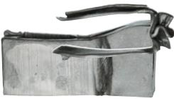
**2** Auf einer Schmiedepresse wird der rotglühende Rohling verformt und das Axtauge gelocht. Überschüssiger Grat wird entfernt.
