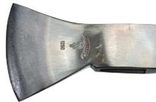
**5** Dauerhafte Kennzeichnung durch Stempelung mit dem Herstellerkennzeichen. Das Vergüten (Härten und Anlassen) der Axtschneide gewährleistet die Härte und Zähigkeit.
