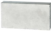
**1** Von gewalztem Vergütungsstahl C60 werden die Schmiederohlinge abgesägt.
