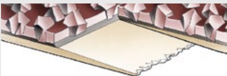
Typ 1: Überlappende Verbindung ohne Kornabschliff
