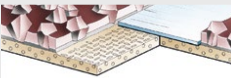
Typ 4: Gestossene Verbindung mit kornseitiger Spezialfolie
