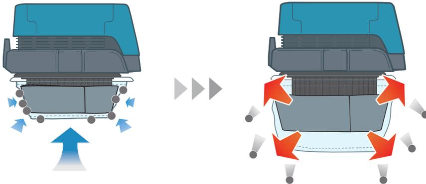
Beim Einschalten des Staubsaugers wird der Vorfilter über den Schaumstoff- und Feinfilter angesaugt.
